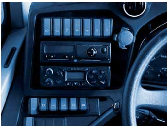
SDC Coach: система интегрированного управления с водительского места, адаптируемая к шасси автобуса, стране применения и т.д.
