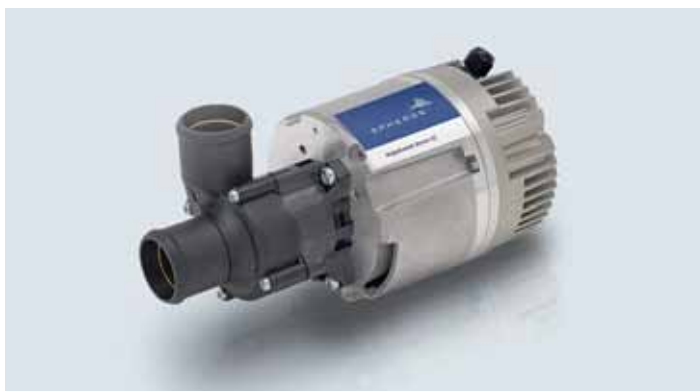
Aquavent 6000 SC: новейший жидкостный насос с магнитной муфтой и бесщеточным электромотором
